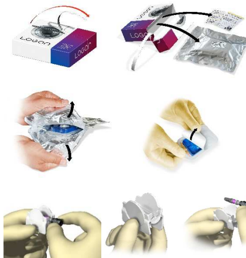
Abbildung 3: Öffnen der Verpackung; Entnahme Folie und Labels; Öffnen der Folie; Öffnen des Blisters; Entnahme der Klemmhalterung aus der OP-Box; Entriegeln der Klemmhalterung durch Zusammendrücken der unteren Klemmbacken; Entnahme des Implantats.
