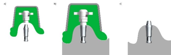
Abbildung 16: Gerades Vario-Abutment – Positionierung der Einheit aus Laborimplantat und Abdruck (a), Ausgießen mit Superhartgips (b) und fertigtes Modell (c)
